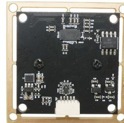
YDS-USB1A-GC1054 V1.0 ist ein 1MP-USB-Kameramodul mit festem Fokus basierend auf einem 1/4" GC1054-Bildsensor. Es liefert ultrascharfe Bilder mit hoher Geschwindigkeit und 720P-Auflösung.
